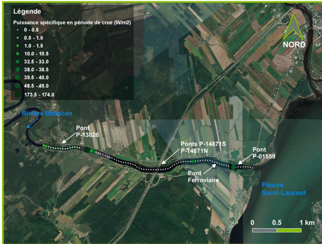
Figure 3.8 : Puissance spécifique en condition de crue
