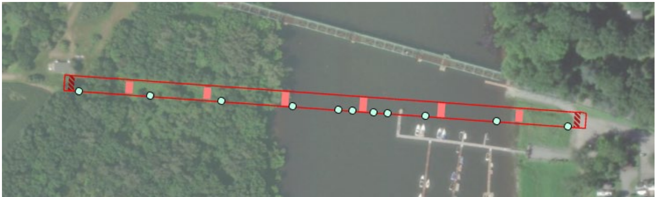
Figure 3.3 Position des drains de tablier
