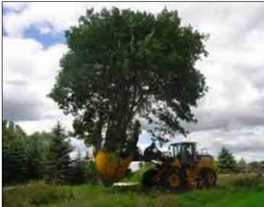
Photo 3 : Transplanteuse mécanique de 90 po. de diamètre montée sur une chargeuse [source: Environmental Design & Davey Tree Expert ]
