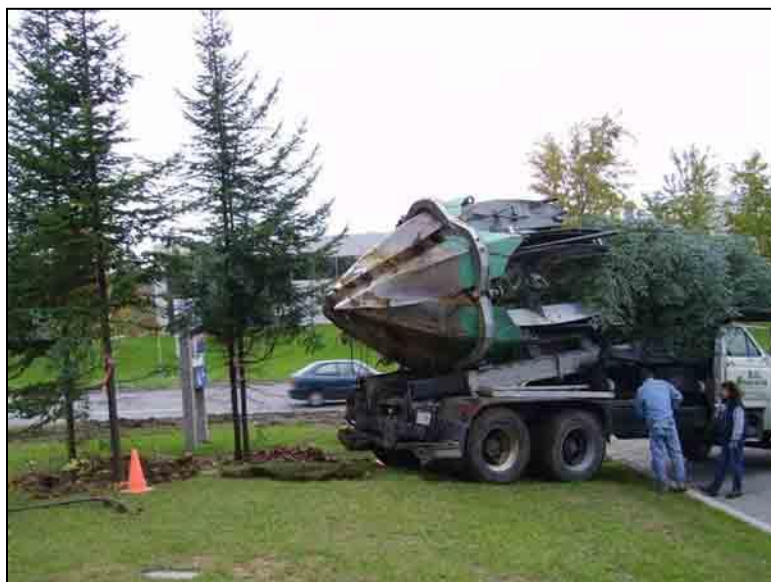
Photo 4 : Transplanteuse mécanique de 84 po. de diamètre montée sur un camion 10-roues, transplantation d'arbres de fort calibre [source: NFU, projet Les Brasseurs du Nord, Blainville ]
