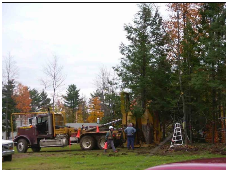
Photo 5 : Transplanteuse mécanique de 84 po. de diamètre montée sur un camion 10-roues, transplantation d'arbres de fort calibre [source: NFU, projet Les Brasseurs du Nord , Blainville]
