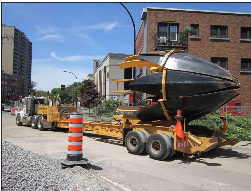
Photo 9 : Arracheuse mécanique de 110 po. de diamètre montée sur camion en semi-remorque [source: NFU, projet ch. Remembrance/Côte-des-Neiges, Montréal]
