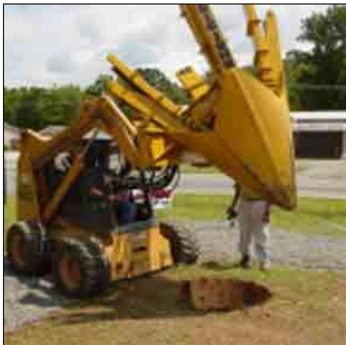
Photo 1 : Transplanteuse mécanique de 42 po. de diamètre montée sur un petit tracteur-chargeur [source: Big John Tree Transplanter ]
