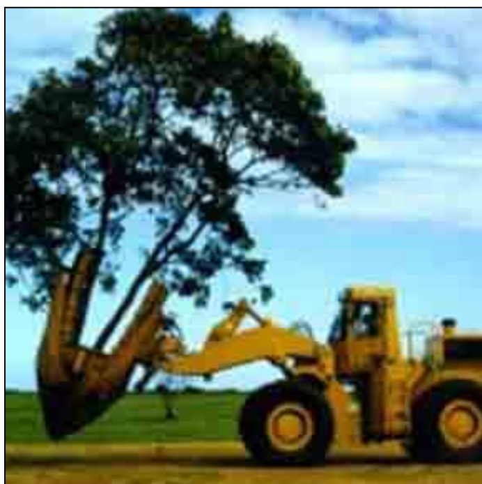
Photo 2 : Transplanteuse mécanique de 90 po. de diamètre montée sur une chargeuse [source: Big John Tree Transplanter ]
