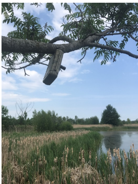
Photo 1. Détecteur d'ultrasons Anabat Swift placé à la station STCTB_01 en bordure de la station de pompage de la sablière.
